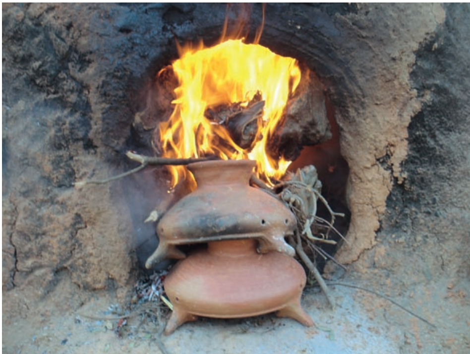
Foto 15. Horno en proceso de combustión que durará toda la noche.
