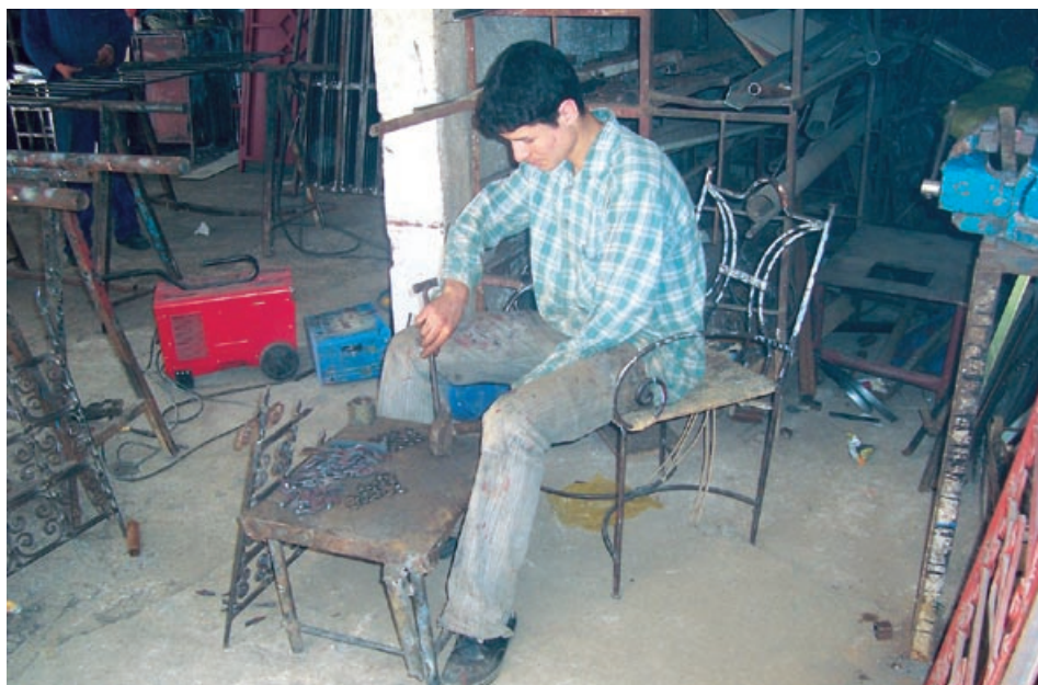
Foto 2. Operario realizando el doblado.
